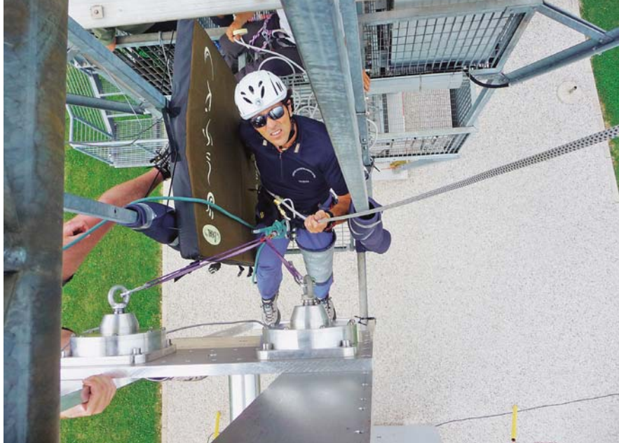
Sopra, una prova di confronto sulle tecniche di assicurazione (Torre, 2014). A sinistra, prove a trazione su Abalakov (Laboratorio, 2019). A destra, prove di tenuta su nodo mezzo-barcaiolo (Rocca Pendice, 1979)
