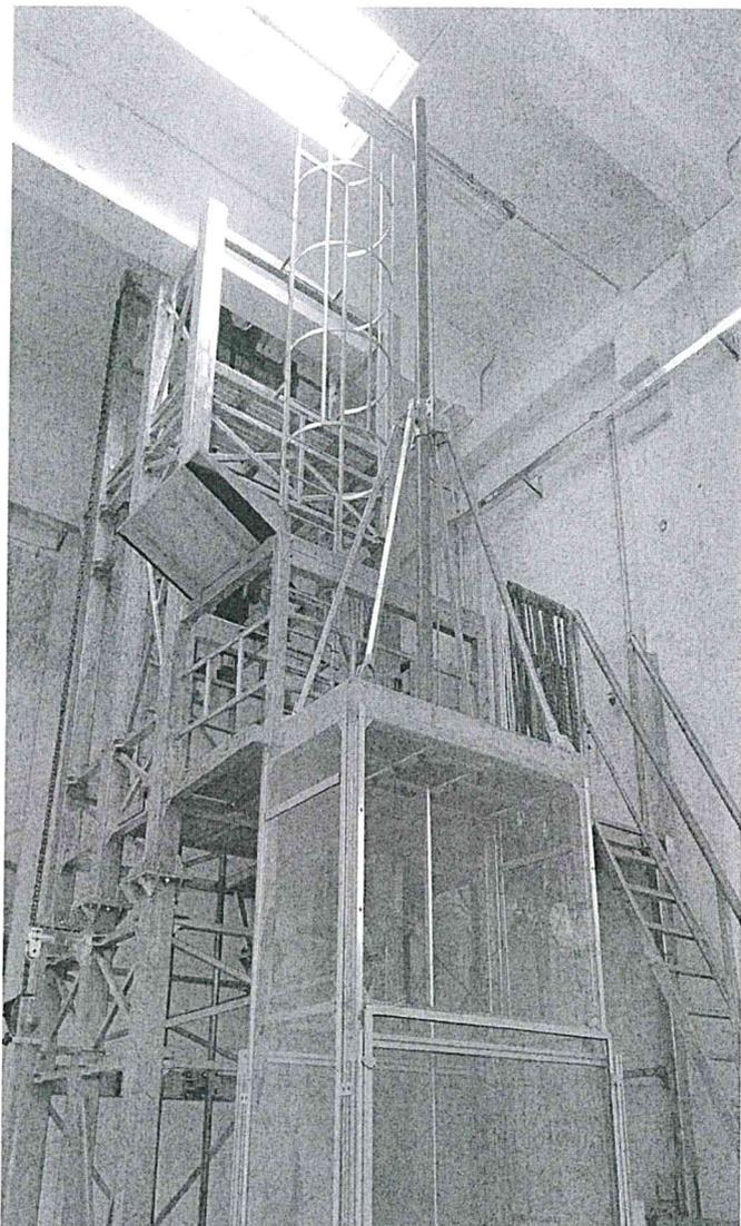
1. Torre Materiali e Tecniche detto "Dodero": è una torre posizionata all'interno del capannone, alta circa 6.00 mt. avente lo scopo di eseguire le prove di resistenza alla trazione, con peso verticale, su corde in uso nell'attività alpinistica; l'accesso all'area di prova, quest'ultima posizionata ad un'altezza di circa 3 mt. , avviene a mezzo di una scala ripida.
