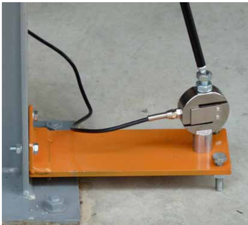
In alto da sinistra: la cerniera orientabile della sonda. La cella di carico punta della sonda. Il fissaggio cucchiaino.
