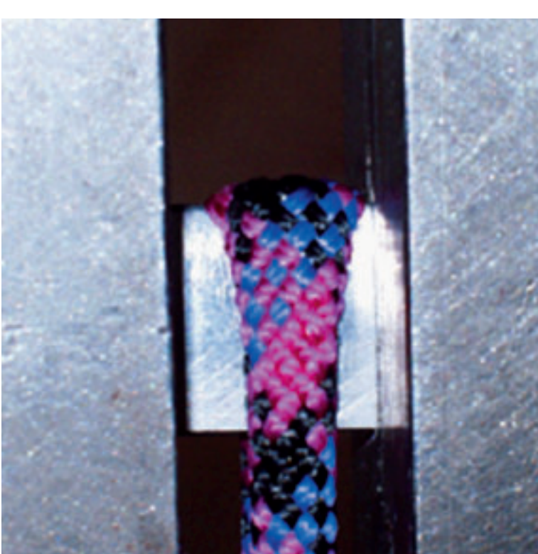
Fig. 2 effetto dello spigolo sul cordino.
