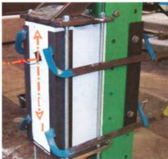
Figura 5: Il blocco di calcestruzzo in sostituzione del ghiaccio, 1 direzione radiale, 2 direzione assiale
