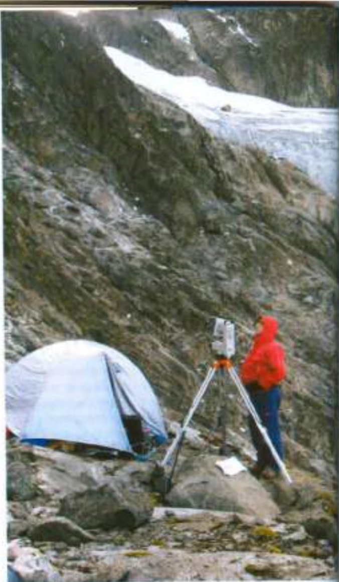
Dal sopra: Le operazioni di scansione della fronte del ghiacciaio Speke (Vassena - 2006).
