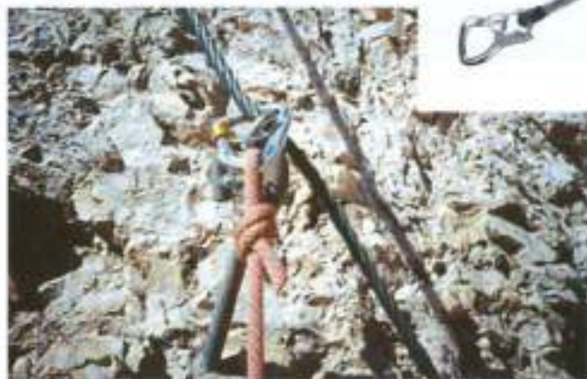
Sopra: il dissipatore tipo "a Y", l'unico accettato dalla UIAA.
